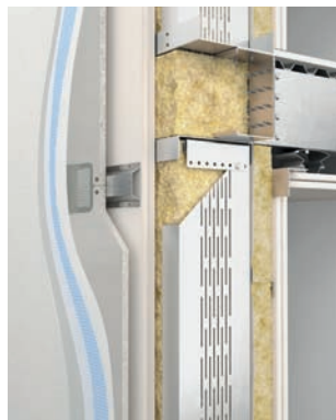
Наружная стена — здание из ЛСТК
