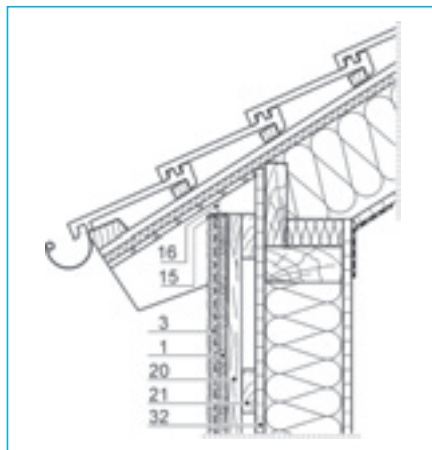
Примыкание к крыше (1)
